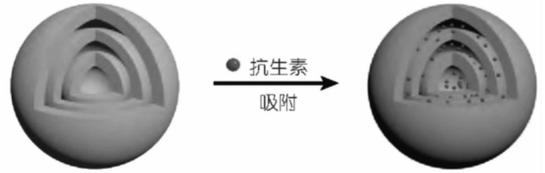
图8 多层空心MOFs材料吸附水体中抗生素示意图
