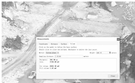
图9 下游围堰填方量
