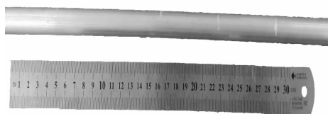
图 6 通过热挤压得到的铝合金棒材图
